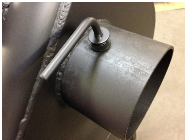
Рис. 4 — Регулятор выхода отработанных газов: ЗАКРЫТ • режим газификации
