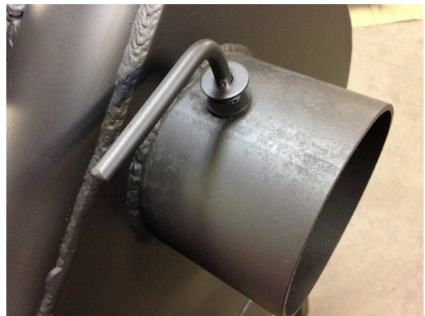
Joon. 4 — Suitsugaaside väljalaskeklapp: SULETUD • gaasistamisrežiim
