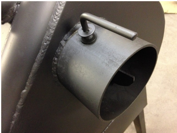
Joon. 1 — Õhu juurdevoolu regulaator: AVATUD • intensiivrežiim
